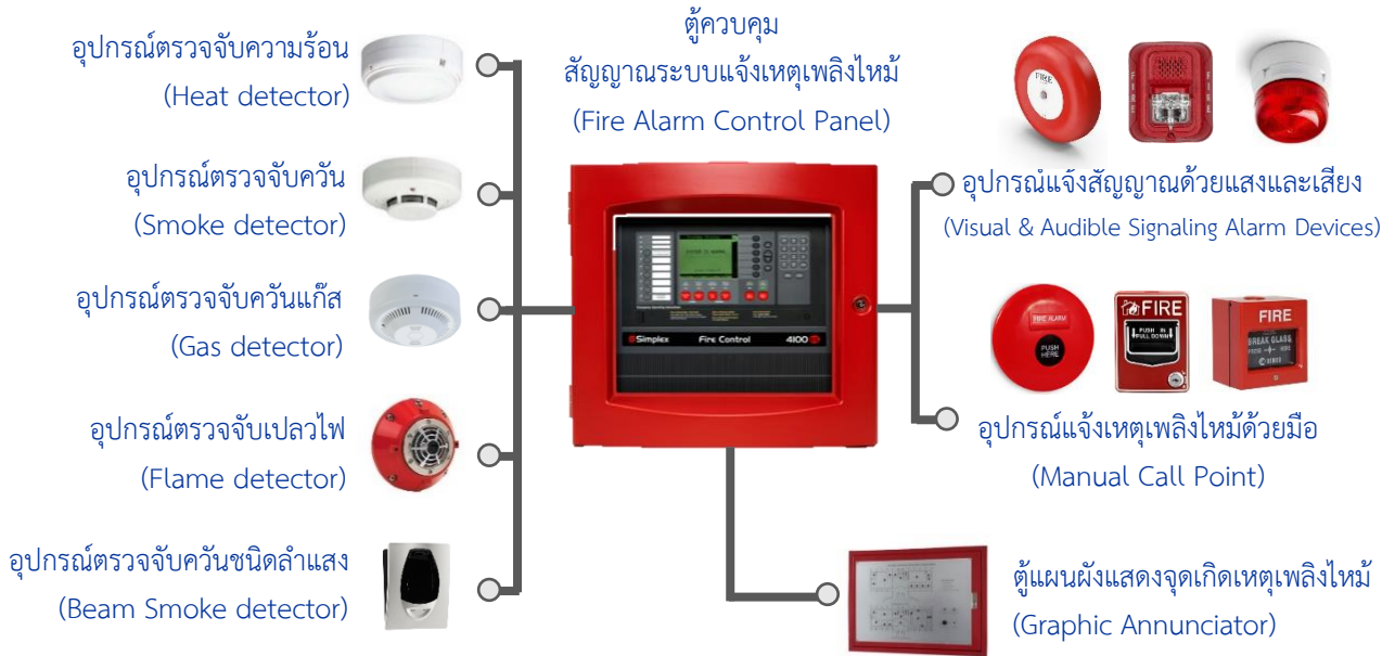
รูป 2 อุปกรณ์ของระบบแจ้งเหตุเพลิงไหม้
