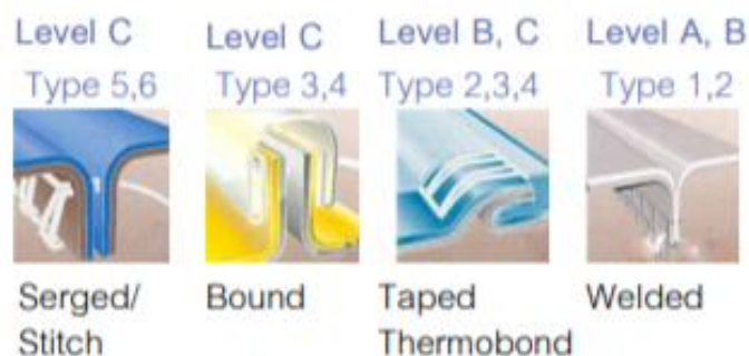
รูป 4.2 ตะเข็บชุดป้องกัน (Seam Construction)
